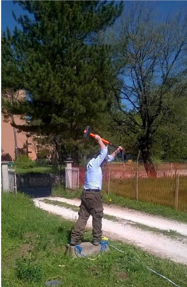
**Figura 3.** Battuta trasversale (HF - *Horizontal Force*) per la generazione delle onde di Love.
