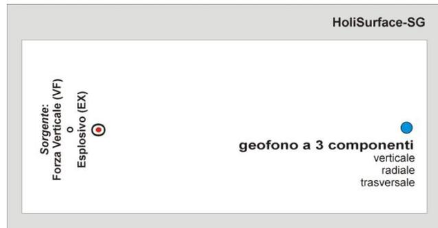
**Assetto del geofono 3C per analisi *HoliSurface*<sup>®</sup>:** a seconda del tipo di sorgente adottata potremo acquisire tanto le onde di Rayleigh (componente radiale e verticale) che di Love (componente trasversale).
