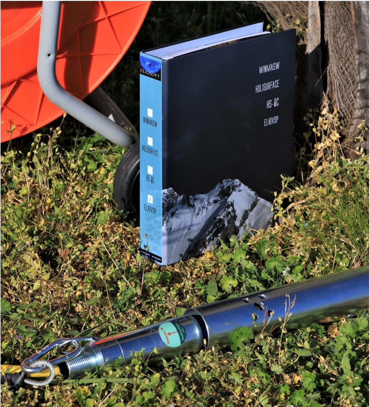
**GEOFONO DA FORO CON DOPPIO SENSORE** (due geofoni 3C posti a 1 m di distanza l'uno dall'altro). Per dettagli [vedi il manuale di ELIOVSP](#), il nostro software per l'analisi congiunta di dati di pozzo e curva HVSR.
