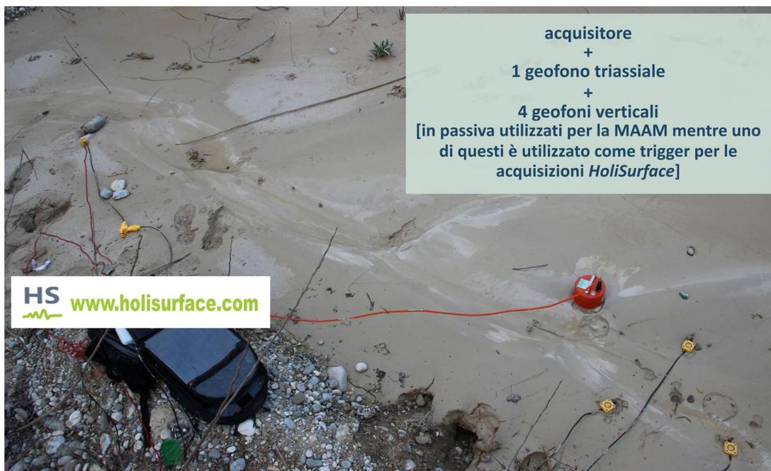
**Acquisizione HS per la ricostruzione delle velocità ( $V_s$ ) dei fanghi di lavaggio di una cava. Si può notare come sia stata eseguita anche una MAAM e come il geofono centrale sia ora invece utilizzato come geofono trigger per la sismica attiva HS.**
