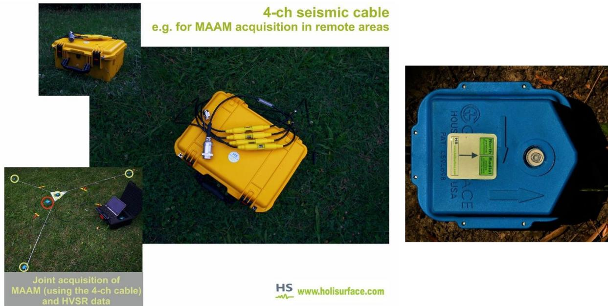
Nel caso di acquisizioni congiunte MAAM + HVSR, ad un connettore del sismografo colleghiamo il **triassiale HOLI3C** e all'altro connettore il cavo da 4 (foto qui sopra).
