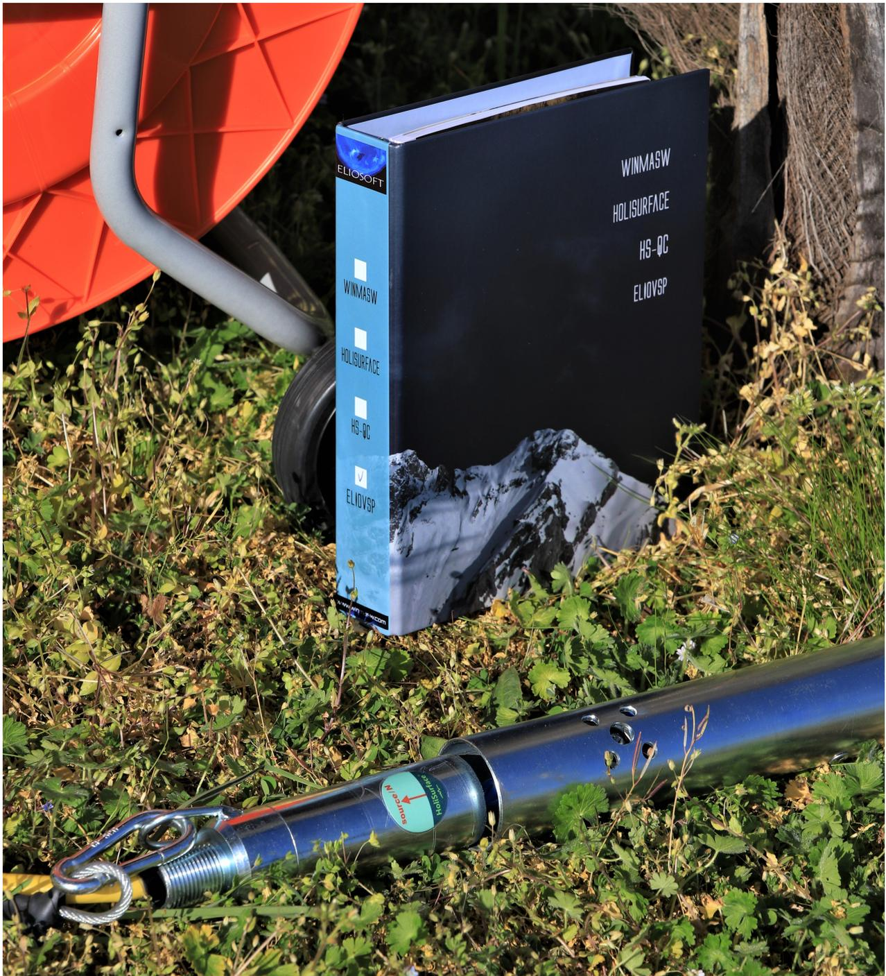
Geofono da foro con *doppio sensore* (due geofoni 3C posti a 1 m di distanza l'uno dall'altro). Per dettagli vedi manuale ELIOVSP (il nostro software per l'analisi congiunta di dati sismici di pozzo e curva HVSR).
