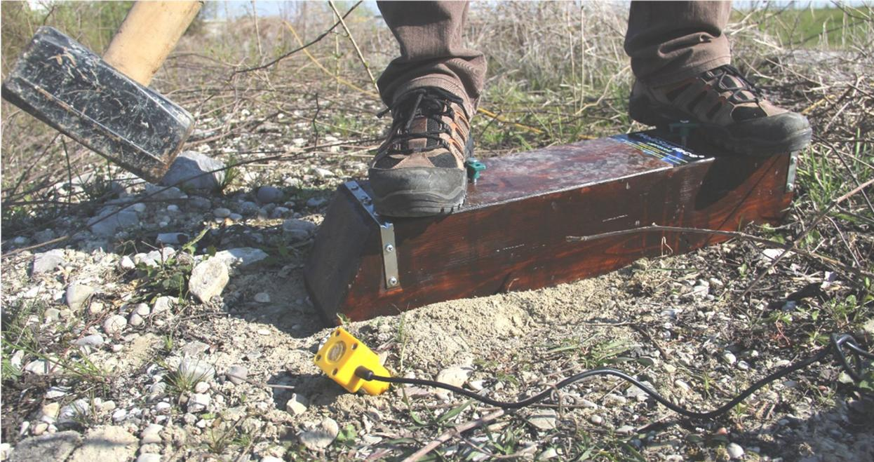
Al fine di evitare danneggiamenti, puoi anche coprire la traversina con la piastra di polietilene utilizzata per le acquisizioni VF.
