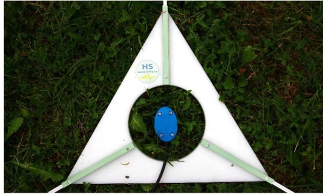
**piastra di battuta in polietilene** (per sismica attiva): leggerezza, robustezza ed efficienza
