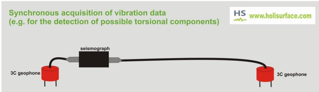
**Sistema HoliSurface® 6.0:** acquisizione dati per misure vibrazionali sincrone (analisi dinamica) e, in relazione ad esempio di studi di microzonazione sismica, per la determinazione dello *Standard Spectral Ratio (SSR)*.
