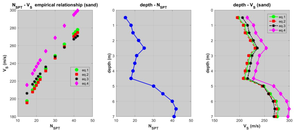
**Software *HoliSurface*<sup>®</sup> 6.0:** *tool* di conversione  $N_{spt}-V_S$  secondo una serie di relazioni empiriche tratte dalla letteratura geotecnica da confrontare con i valori di  $V_S$  che si possono ricavare dall'analisi delle onde di superficie.
